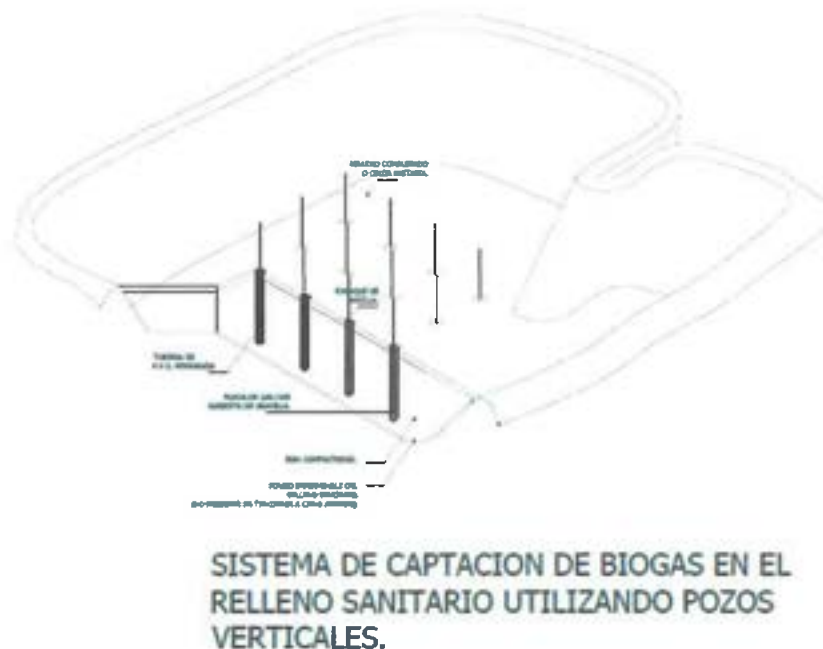
Figura VI.7. Sistema de captación de biogás en el relleno sanitario.
