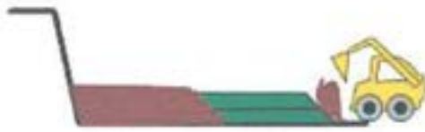
16. Excavación y acarreo de material de cobertura, descargado en los bordes de la celda
