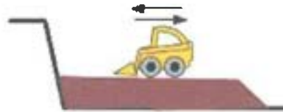
19. Compactación tierra de la parte superior de la celda con al menos 4 pasadas de llantas
