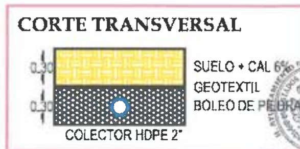
Figura VI.6.- Detalle de colector de biogas.
