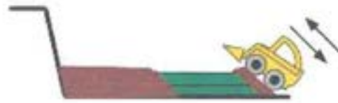
17. Compactación tierra de los bordes con al menos 4 pasadas de llantas
