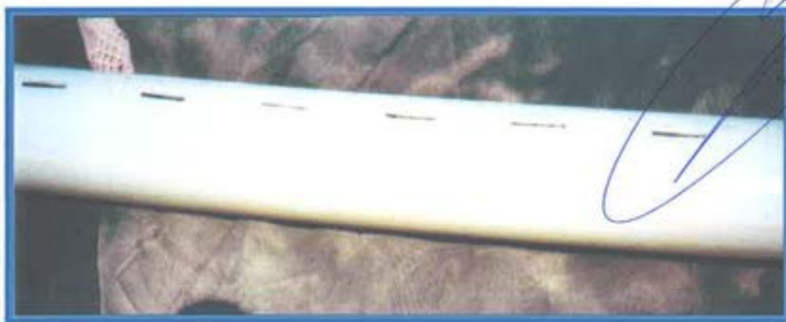
Figura 6.14.- Tubo ranurado, para captación y conducción de lixiviados.
