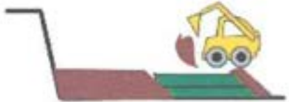
18. Material de cobertura, descargado en la parte superior de la celda
